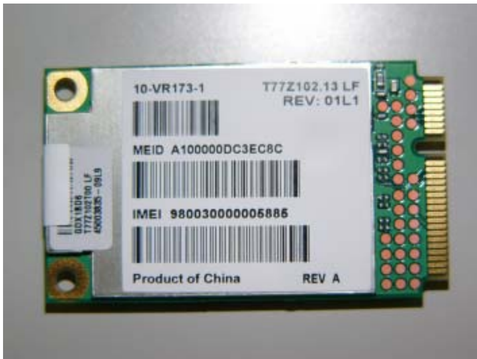
WWAN/GPS(Gobi2000) module Bottom View
