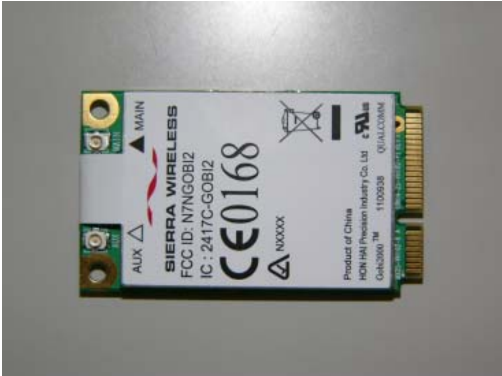
WWAN/GPS(Gobi2000) Module Top View
