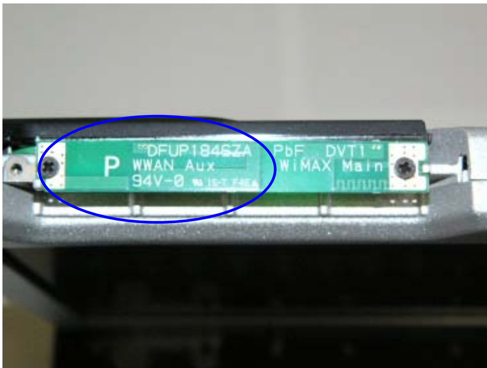
WWAN Aux /GPS(Gobi2000) RX Antenna
