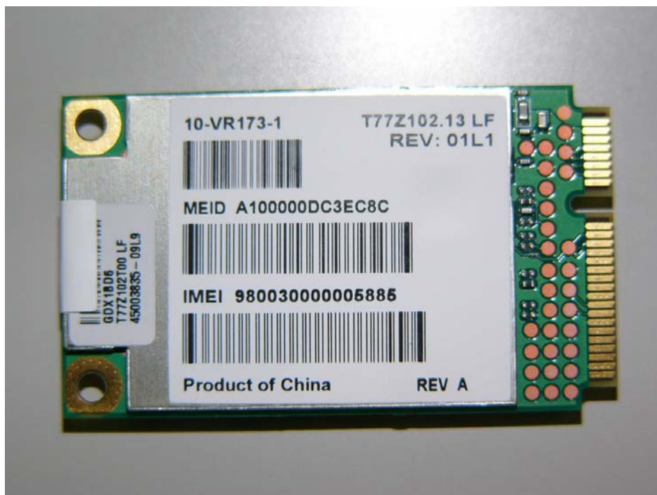
WWAN/GPS(Gobi2000) module Bottom View
