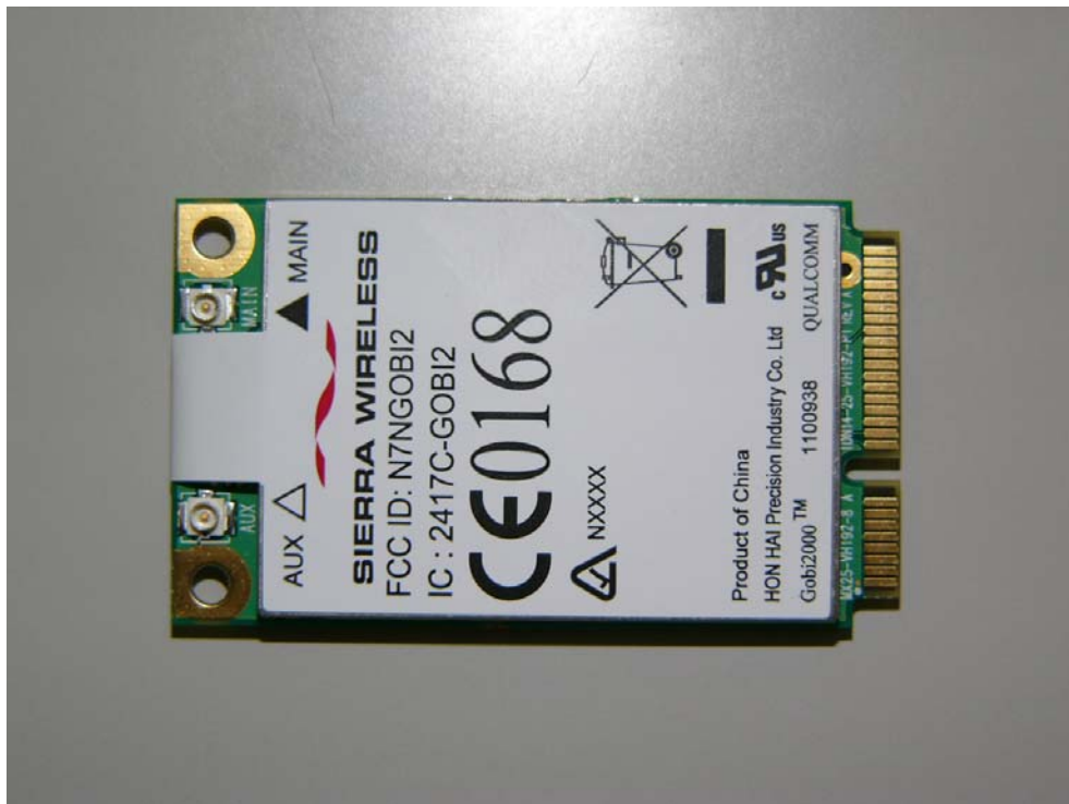
WWAN/GPS(Gobi2000) Module Top View
