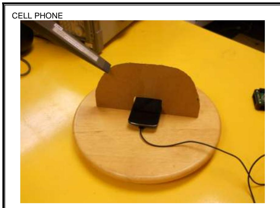
**3-AXIS VLF MAGNETIC FIELD PROBE**
