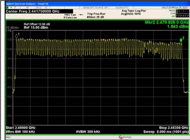
Hopping Plot \pi/4 DQPSK
