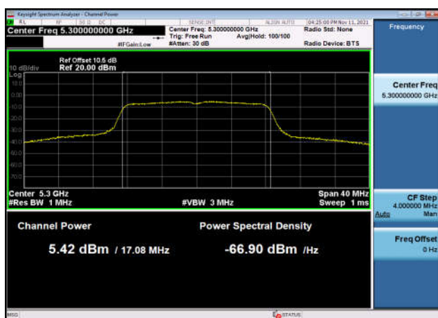
U-NII-2a Output Power-802.11a(20MHz) ,5300MHz,Ant1
