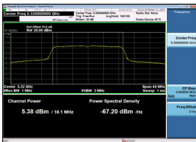
U-NII-2a Output Power-802.11a(20MHz) ,5300MHz,Ant1
