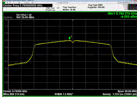
IEEE 802.11n_Channel 157_20MHz_Antenna 0
