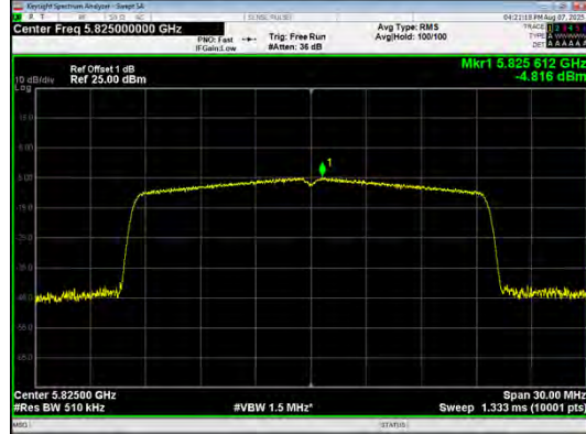
IEEE 802.11ax_Channel 165_20MHz_Antenna 0_RU&amp;Index SU
