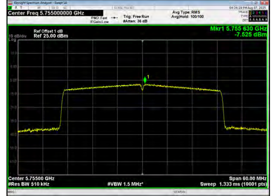
IEEE 802.11ax_Channel 151_40MHz_Antenna 0_RU&amp;Index SU
