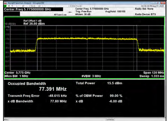
IEEE 802.11ax_Channel 151_40MHz_Antenna 0_RU&amp;Index SU
