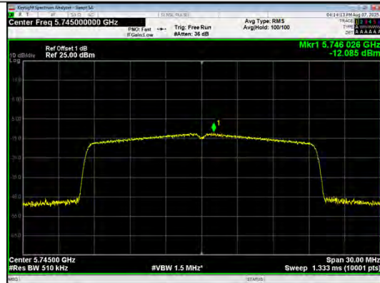
IEEE 802.11ax_Channel 149_20MHz_Antenna 0_RU&amp;Index SU
