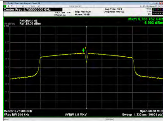
IEEE 802.11n_Channel 151_40MHz_Antenna 0
