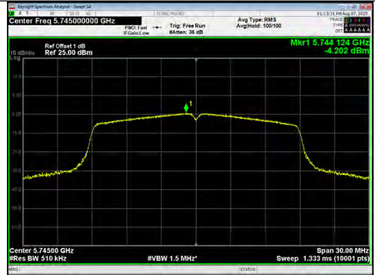
IEEE 802.11n_Channel 149_20MHz_Antenna 0
