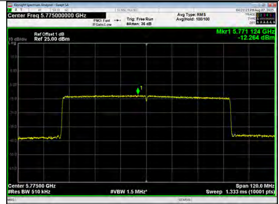
IEEE 802.11ax_Channel 155_80MHz_Antenna 0_RU&amp;Index SU
