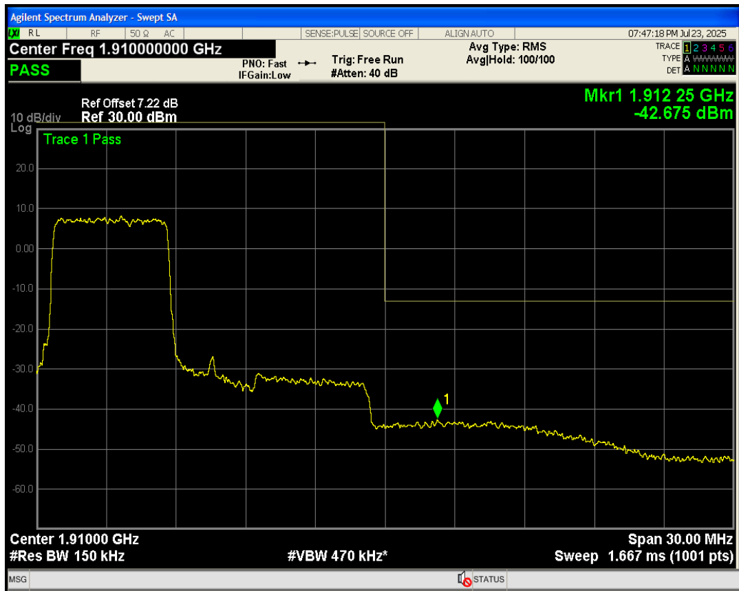
Band2 QPSK BW=20MHz Channel=18700 RB Size=100 Position=#0
