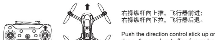
右操纵杆向上推,飞行器前进;右操纵杆向下拉,飞行器后退。
