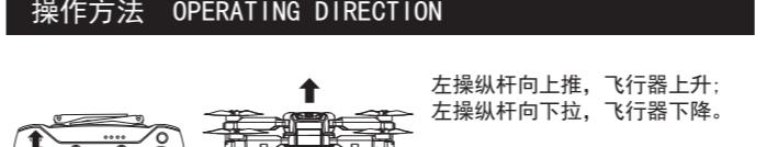
左操纵杆向上推,飞行器上升;左操纵杆向下拉,飞行器下降。
