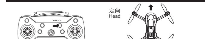
飞行器对频起飞时,遥控器必须正对飞行器尾部,对频完成起飞后,长按遥控器无头模式按键进入无头模式,机身灯光闪烁,同时遥控器蜂鸣器发出“嘀嘀”的响声,再按一下无头模式按键,退出无头模式。
