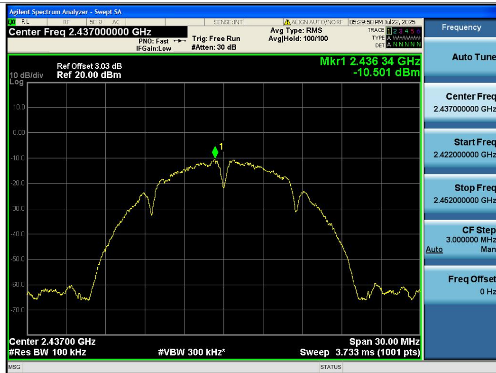
PSD NVNT b 2437MHz Ant1
