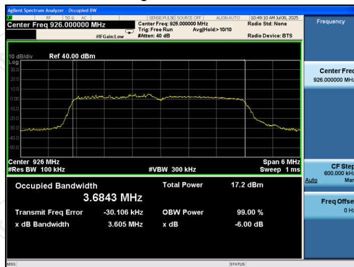
802.11ah 64QAM Modulation
