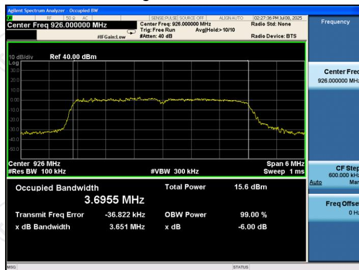
802.11ah 64QAM Modulation
