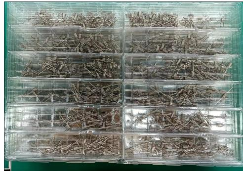
第一步：弹簧使用塑料盘分格放置，料盘叠加后外部用保鲜膜包裹
