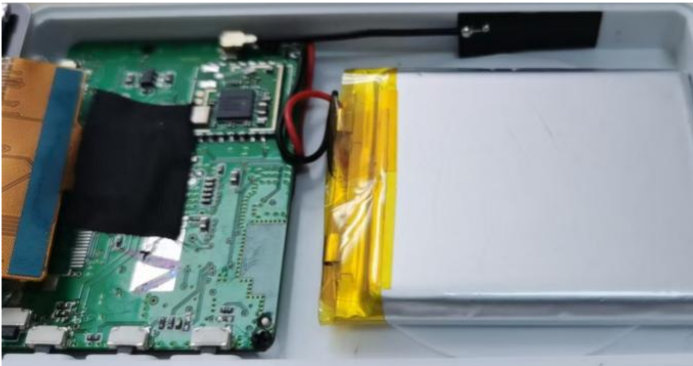
T18机型WF天线长40mm（1IPEX）
