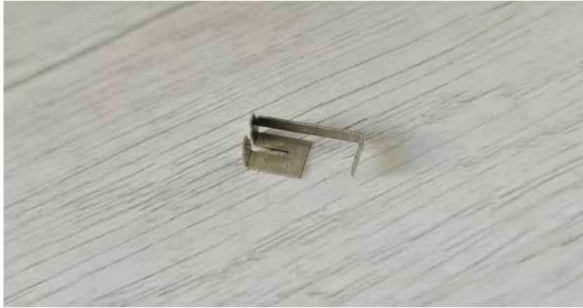
USB 蓝牙天线, 洋白铜 L13.5*W6*H4.3*T0.3mm
