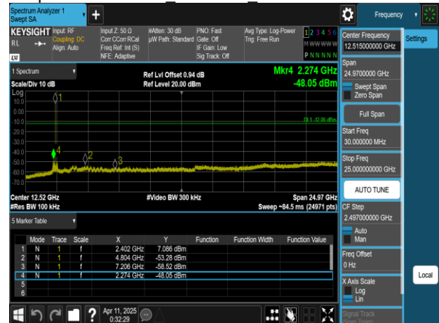
Spurious Emission BLE 500k MidCH20-2442MHz
