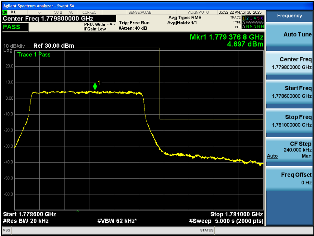
Test_Graph_band66_1779.3MHz_1.4M_16QAM_6RB#LOW_Band edge
