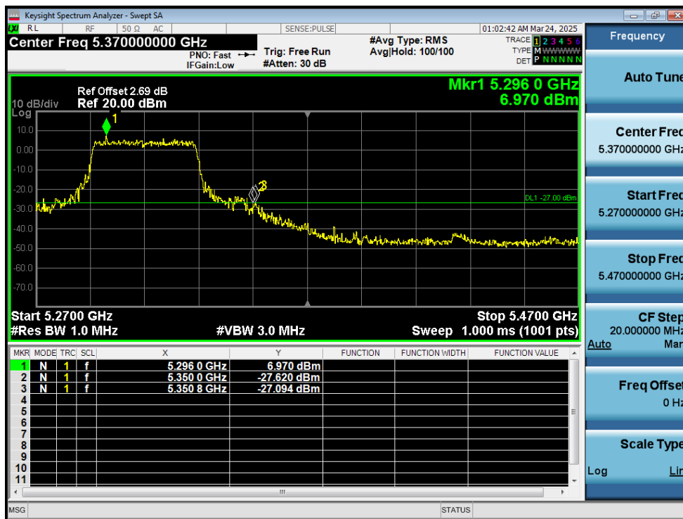
Band Edge NVNT ax40 5310MHz High Ant1
