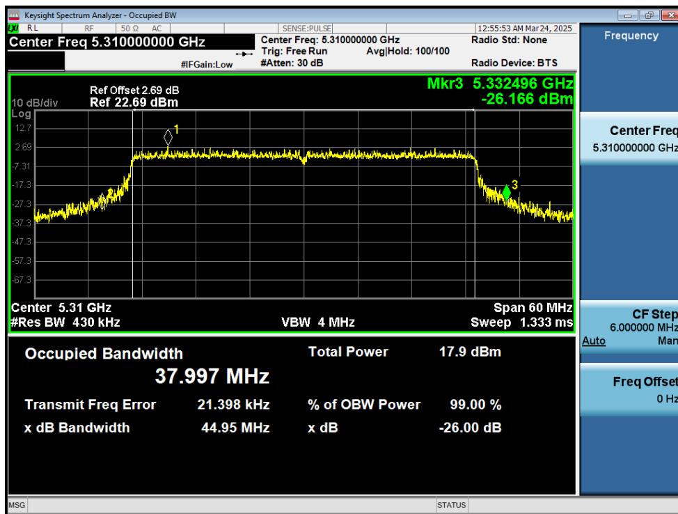
-26dB Bandwidth NVNT ax40 5310MHz Ant1
