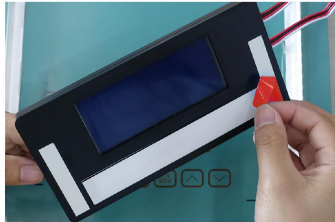
3、将产品面上的屏幕保护膜和双面胶保护膜撕掉，方便下一步安装；
