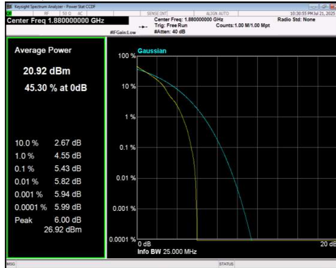
Band2 QPSK BW=15MHz Channel=19125 RB Size=1 Position=#0
