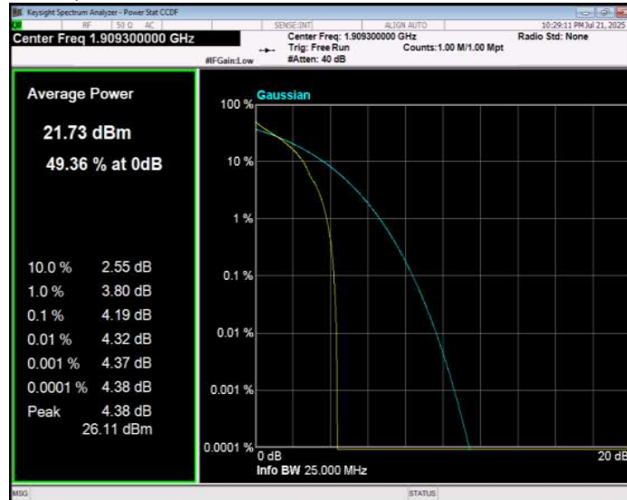
Band2 QPSK BW=10MHz Channel=18650 RB Size=1 Position=#0
