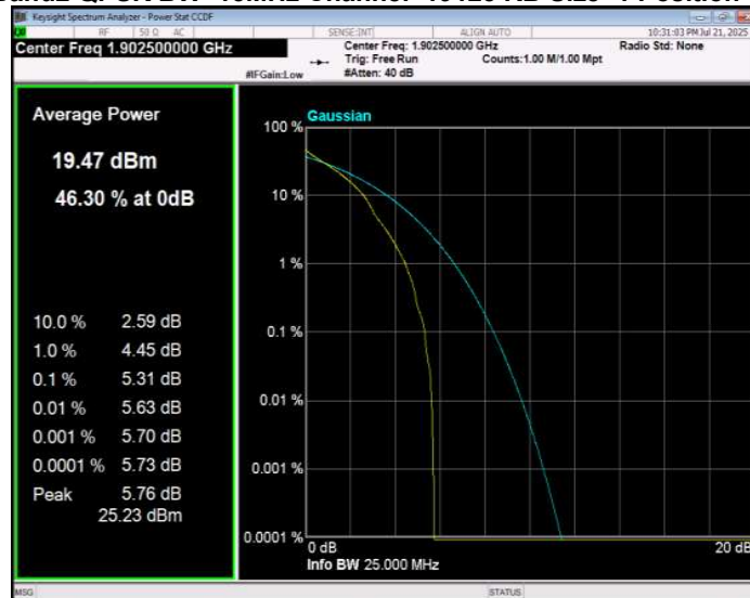
Band2 QPSK BW=20MHz Channel=18700 RB Size=1 Position=#0
