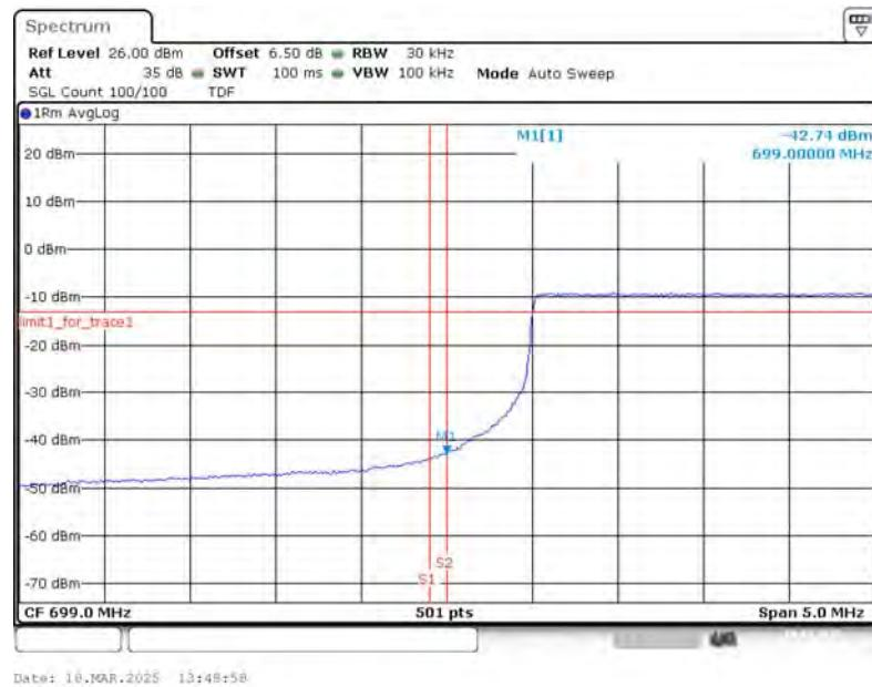
**HIGH BAND EDGE BLOCK-10MHz+20MHz-100%RB**
