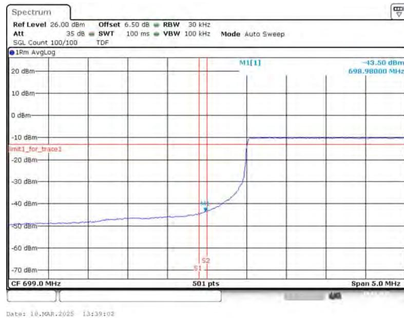
**HIGH BAND EDGE BLOCK-20MHz+10MHz-100%RB**
