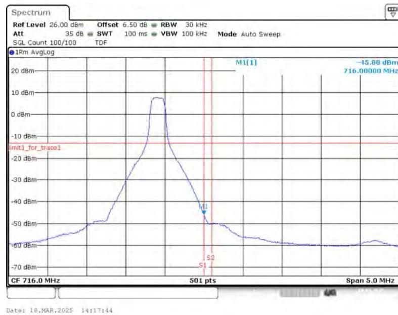
**LOW BAND EDGE BLOCK-10MHz+20MHz-100%RB**
