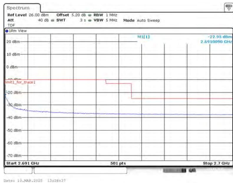
**LOW BAND EDGE BLOCK-20MHz+20MHz-100%RB**
