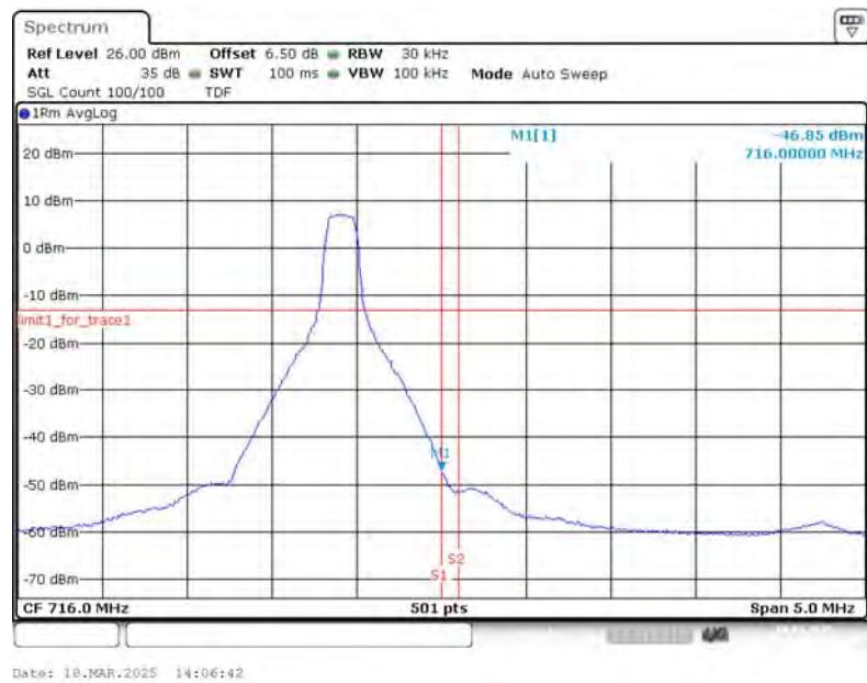
**LOW BAND EDGE BLOCK-20MHz+10MHz-100%RB**
