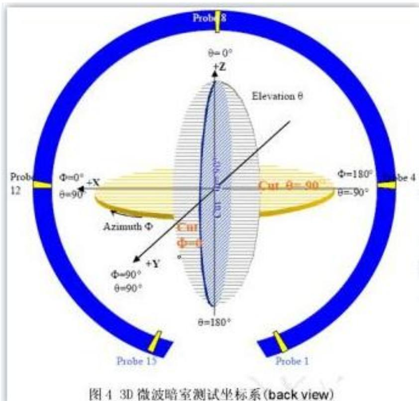
图 4 3D 微波暗室测试坐标系 (back view)
