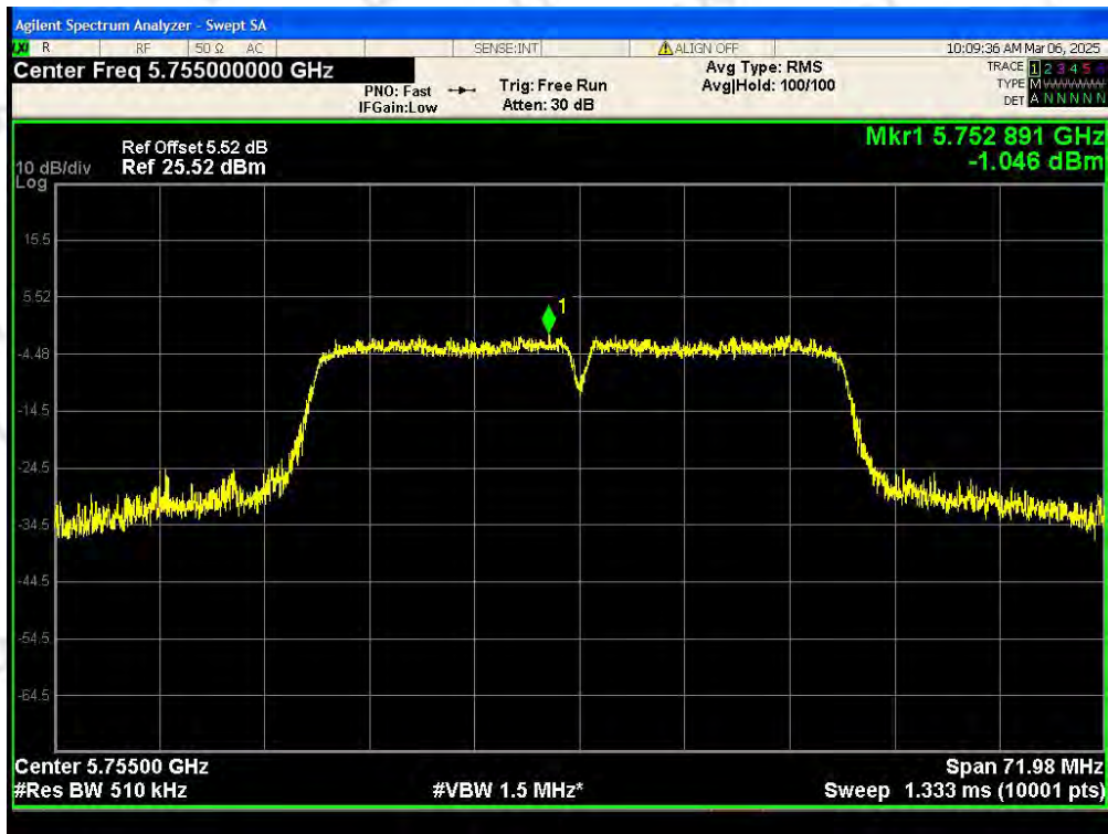
PSD NVNT 802.11ac40 5755MHz Ant1
