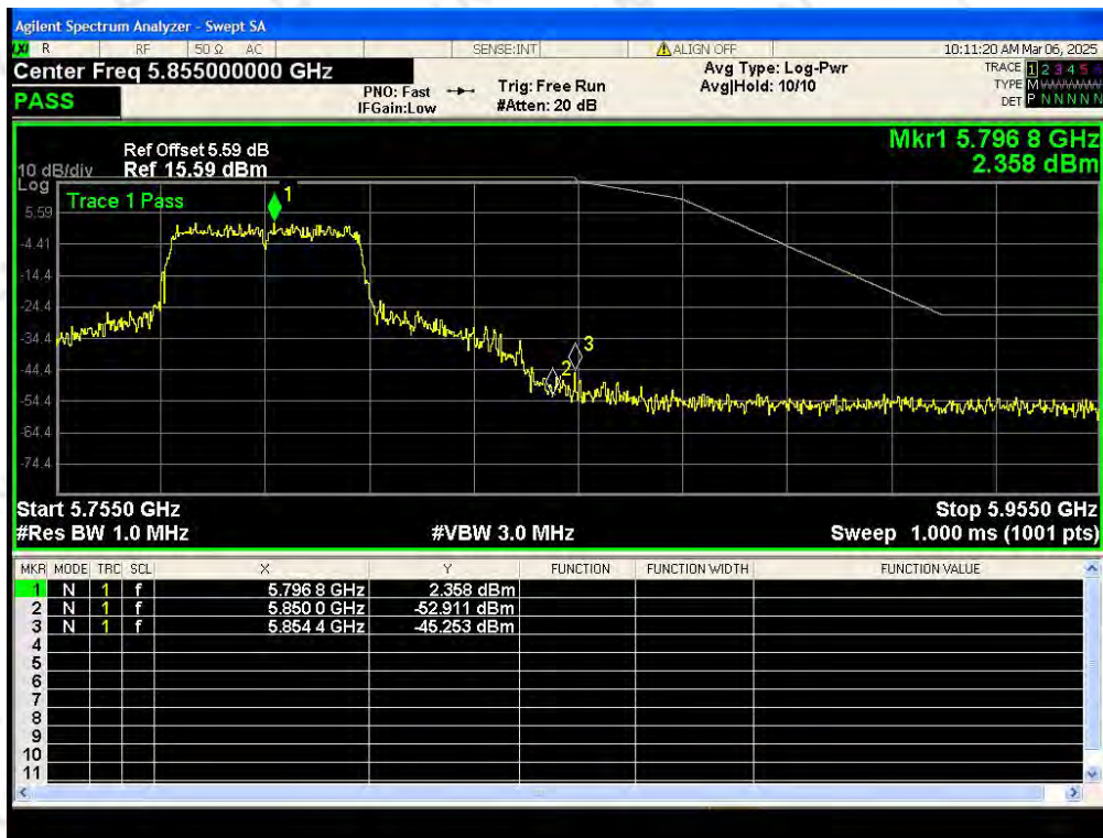
Band Edge NVNT 802.11ac80 5755MHz Ant1
