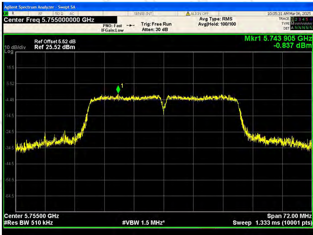
PSD NVNT 802.11n(HT40) 5755MHz Ant1
