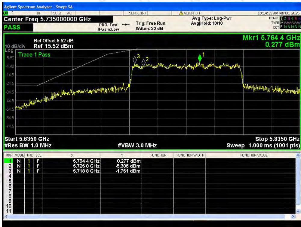
Band Edge NVNT 802.11ac80 5755MHz Ant1
