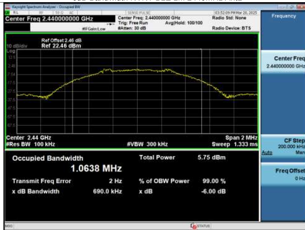
-6dB Bandwidth NVNT BLE 1M 2440MHz Ant1
