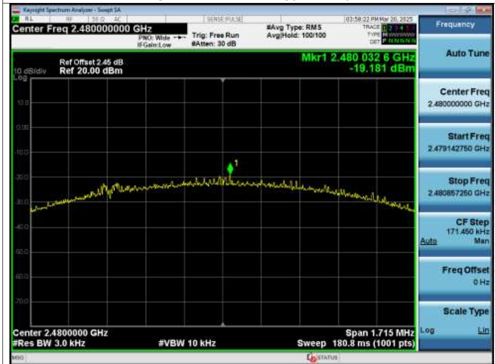
PSD NVNT BLE 2M 2480MHz Ant1
