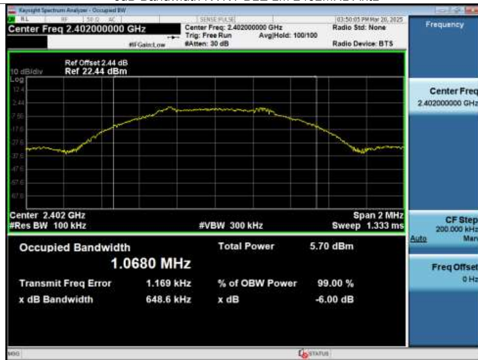
-6dB Bandwidth NVNT BLE 1M 2440MHz Ant1
