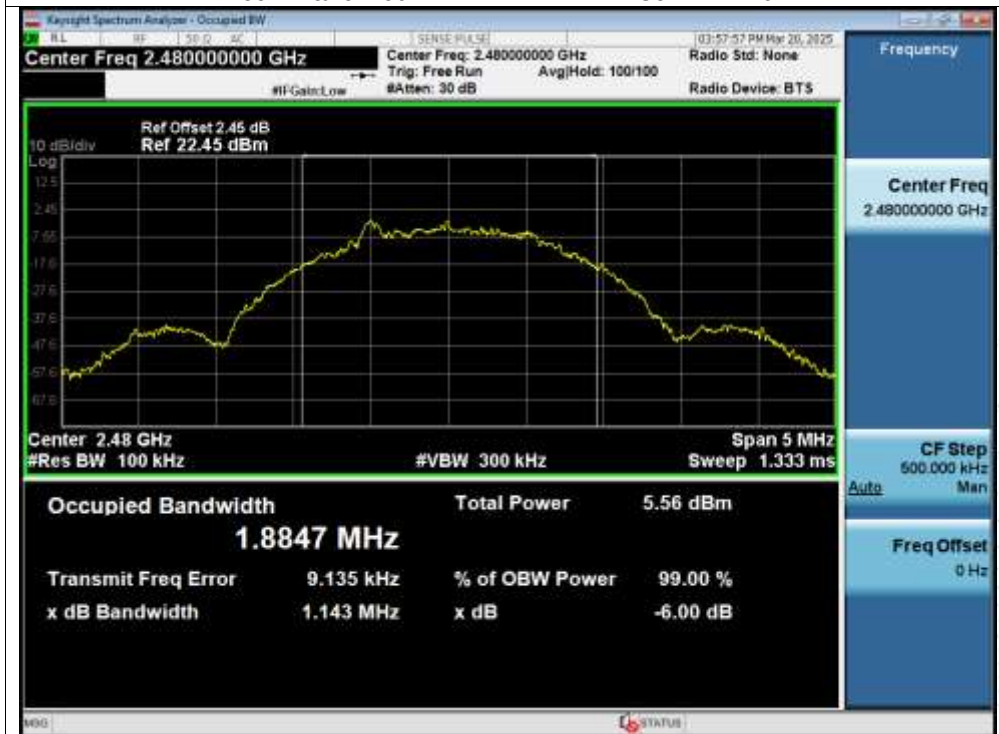
-6dB Bandwidth NVNT BLE 2M 2480MHz Ant1
