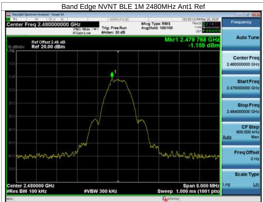
Band Edge NVNT BLE 1M 2480MHz Ant1 Emission
