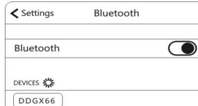
智能眼镜开机后, 打开手机蓝牙搜索设备名**DDGX66**并连接
