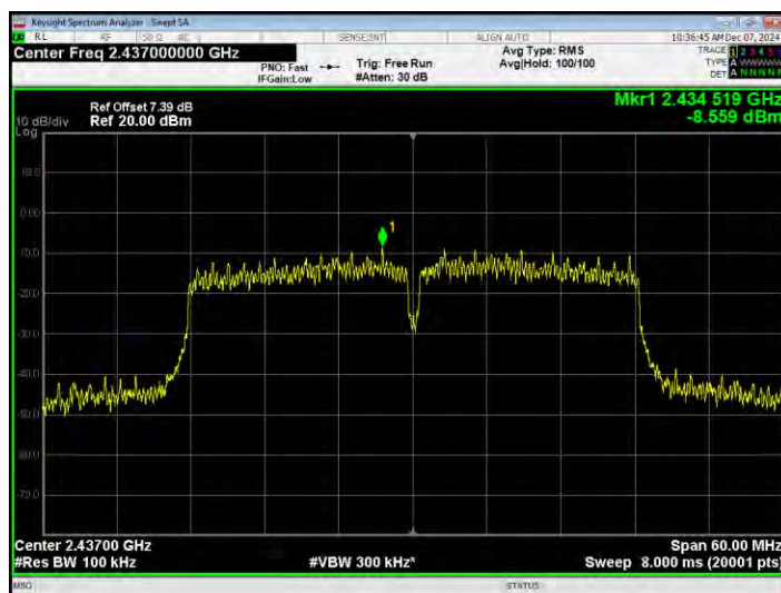
PSD NVNT n40 2452MHz Ant1
