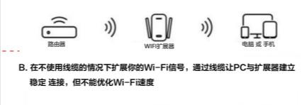
B. 在不使用线缆的情况下扩展你的Wi-Fi信号,通过线缆让PC与扩展器建立稳定连接,但不能优化Wi-Fi速度
