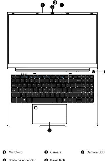
① Microfono      ② Camera      ③ Camera LED
