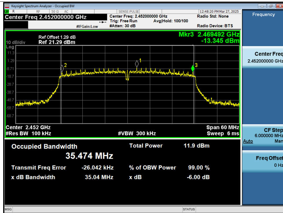
-6dB Bandwidth NVNT n40 2452MHz Ant1
