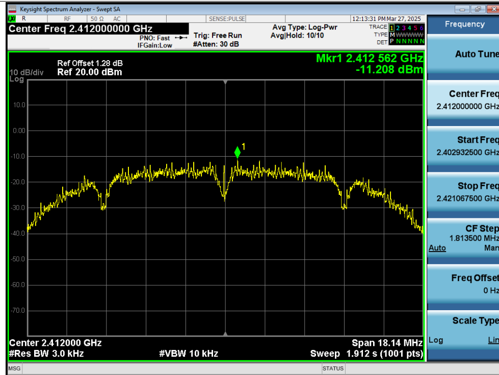
PSD NVNT b 2437MHz Ant1
