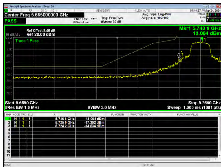
Band Edge NVNT ac20 5825MHz High Ant1
