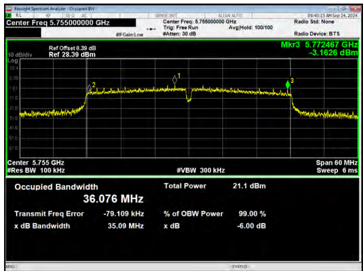
-6dB Bandwidth NVNT n40 5795MHz Ant1
