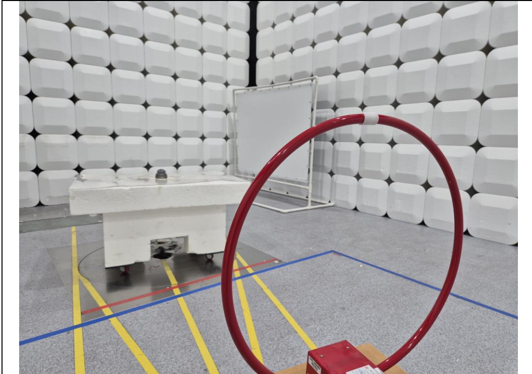
Test distance : 3 m, height of table : 0.8 m
