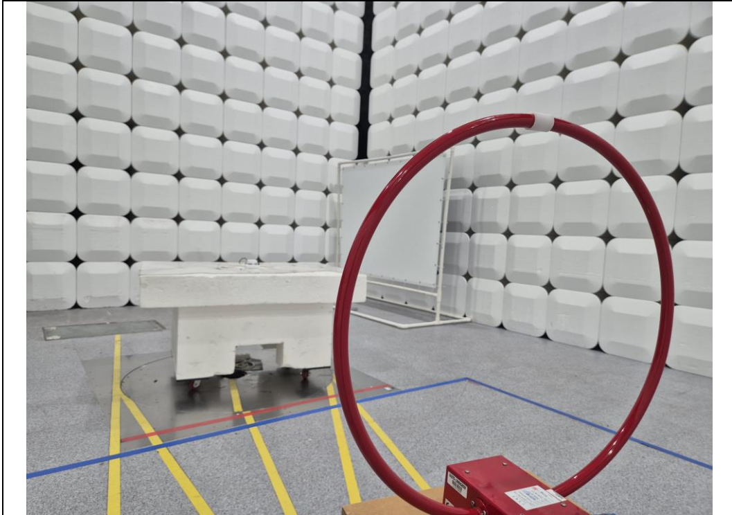
Test distance : 3 m, height of table : 0.8 m
