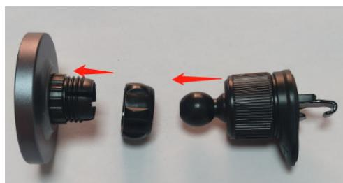
2, 将支架旋转球按压进充电器固定圆孔, 并旋紧充电器螺帽(箭头处螺帽);
