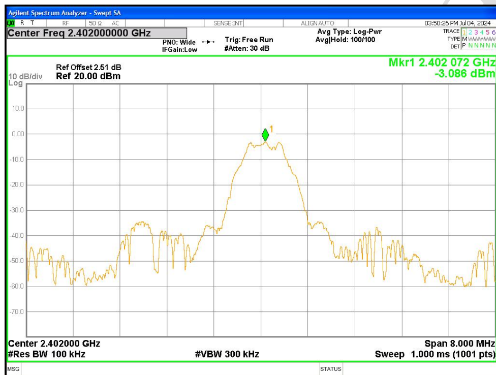
Band Edge NVNT BLE 2402MHz Ant1 Emission
