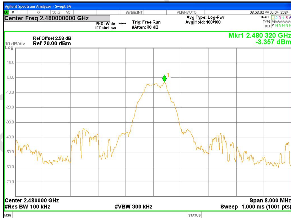
Band Edge NVNT BLE 2480MHz Ant1 Emission
