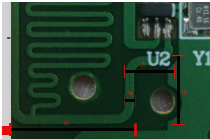
图标的尺寸: ①、4.2mm ②、8.0mm ③、1.2mm ④、1.21cm
