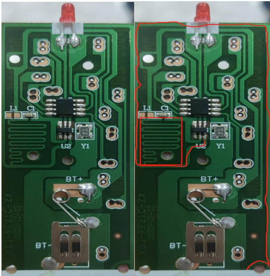
芯片天线：由方框标出的环绕形方式和标出的绕板边形式两部分组成
