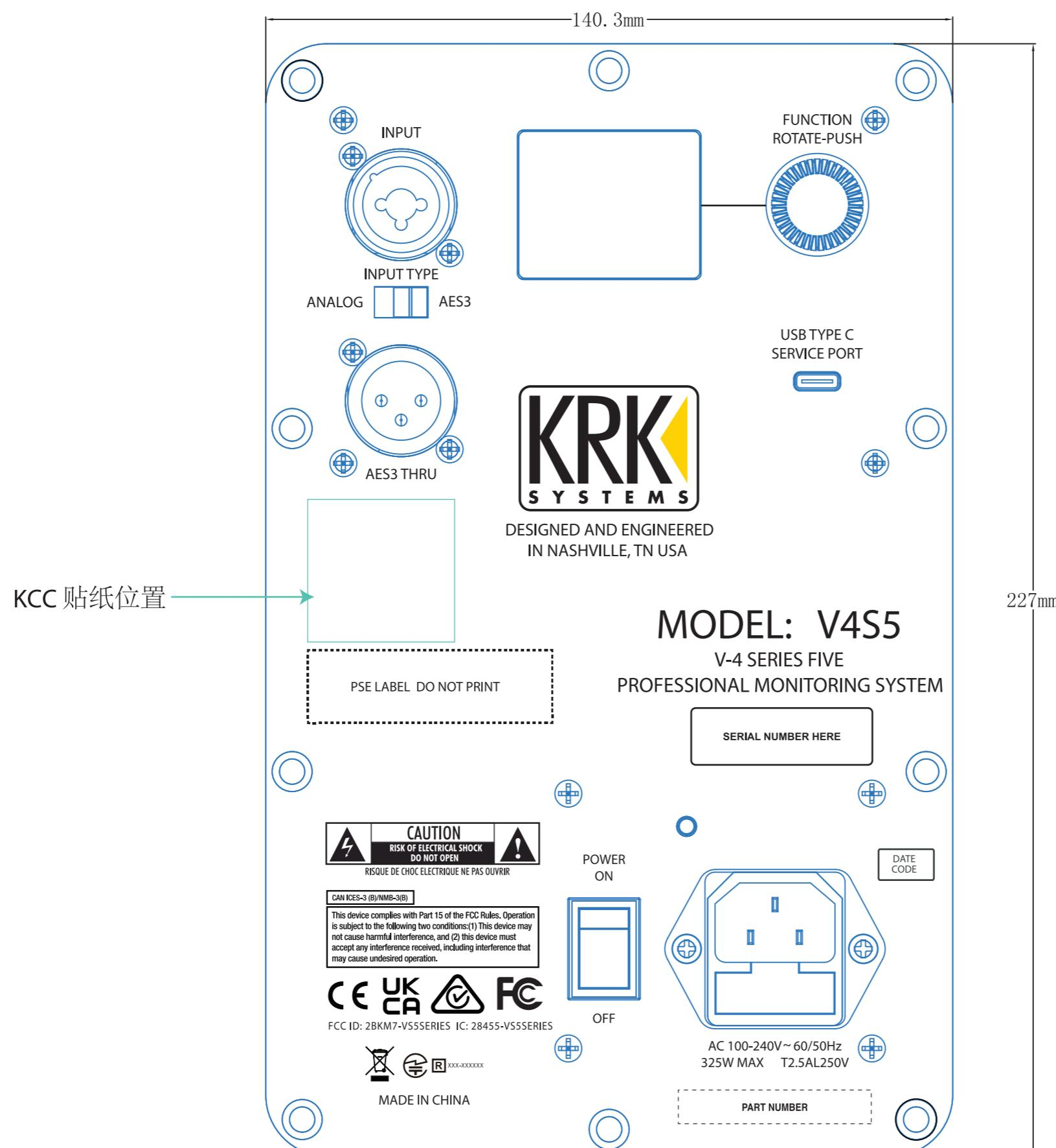
系统规格：,素材:本色,227\*140.3\*1.5MM 镀锌板, 铆柱, V4S5,烤黑织纹漆,丝印白色+黄色(PANTONE 116C),
