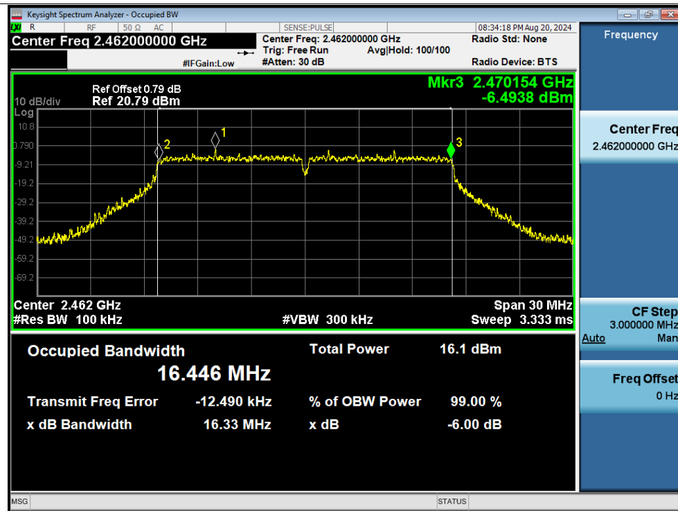
-6dB Bandwidth NVNT g 2462MHz Ant1
