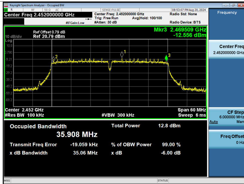
-6dB Bandwidth NVNT n40 2452MHz Ant1
