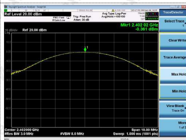
\pi/4 DQPSK (CH39)
