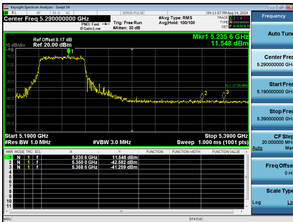
Band Edge NVNT ax40 5230MHz High Ant1
