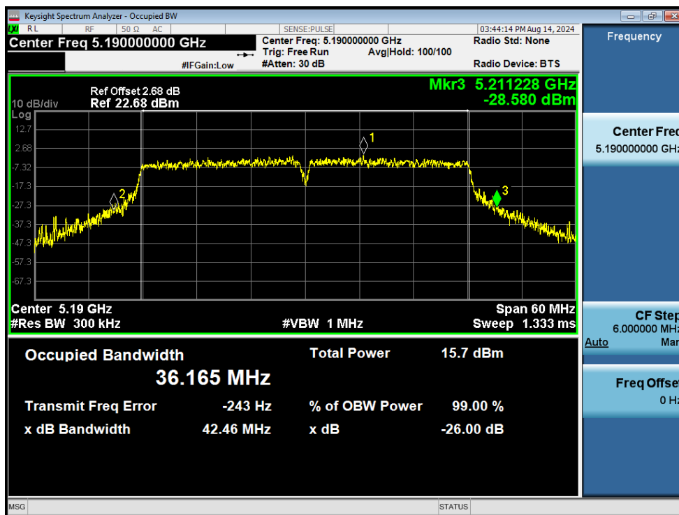
-26dB Bandwidth NVNT n40 5190MHz Ant1
