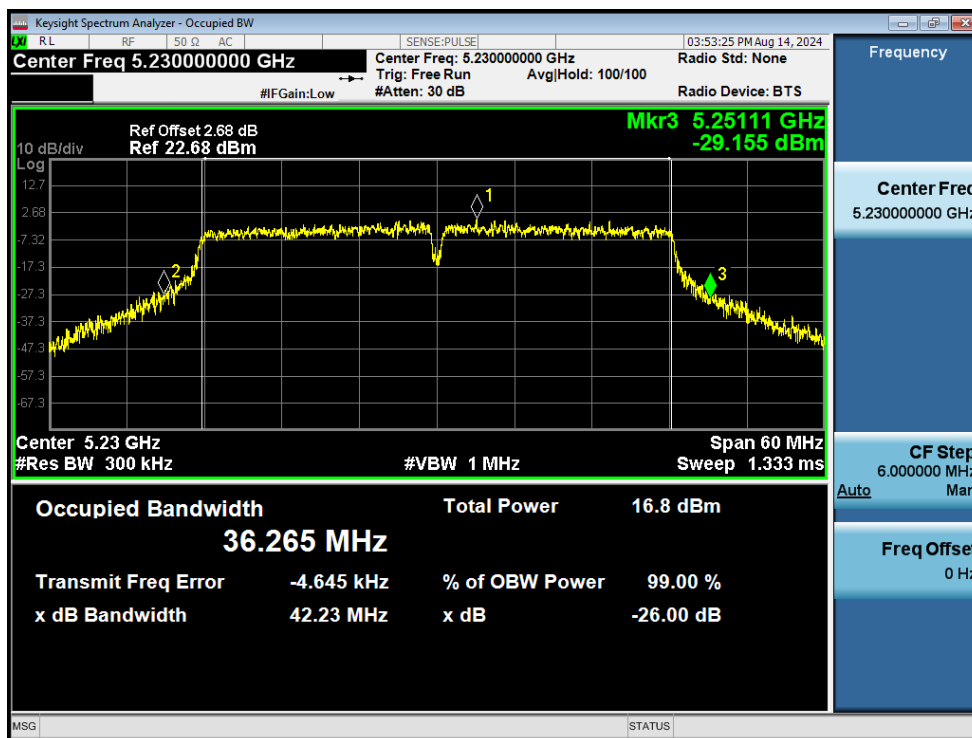
-26dB Bandwidth NVNT ac40 5230MHz Ant1
