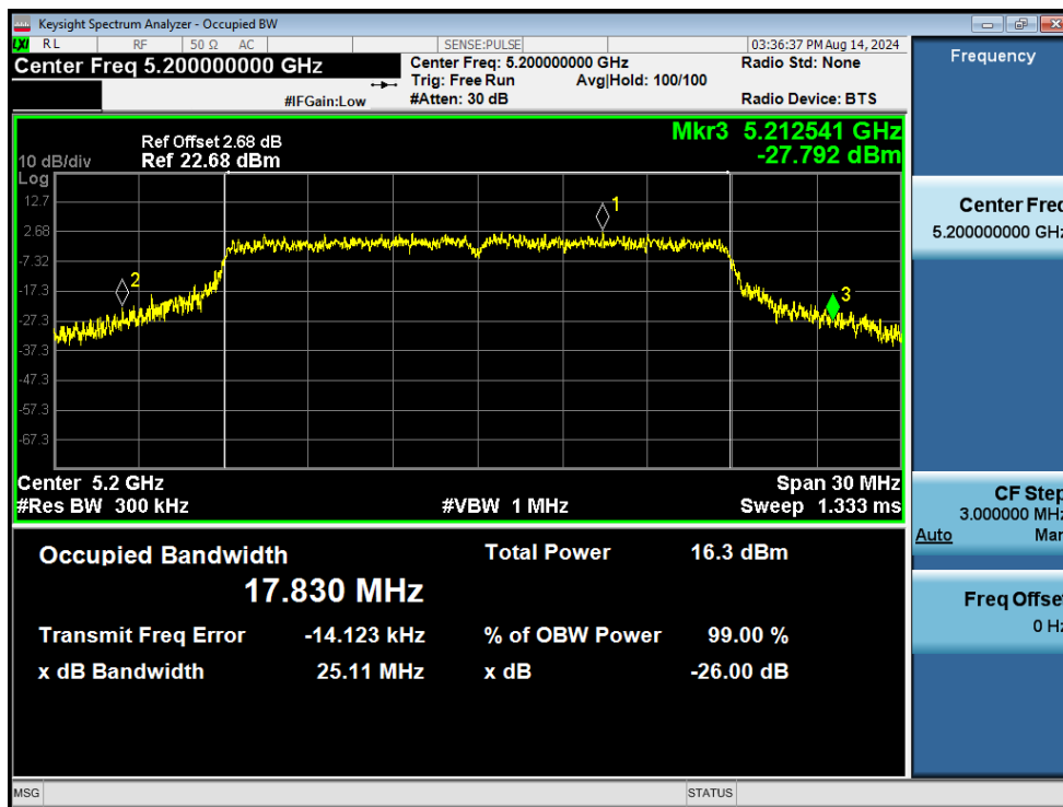
-26dB Bandwidth NVNT ac20 5200MHz Ant1
