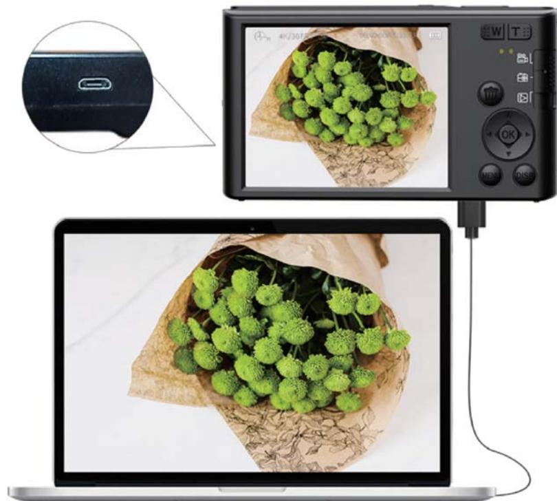
ヒント:充電中にカメラは自動的に電源をオンにします。しかし、充電中にカメラをオフにすると、バッテリーの充電速度が速くなります。
