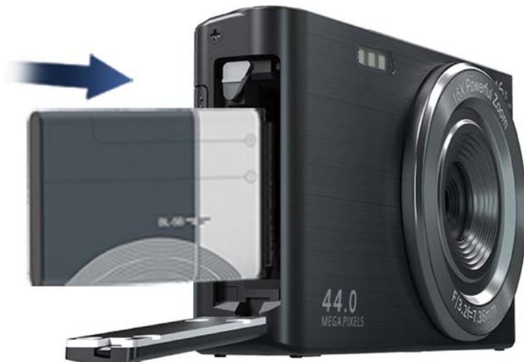
3. 画像に示すように、バッテリーをカメラの正面と同じ方向に向けておき（バッテリーを逆方向に装着すると充電できなくなります）、そしてバッテリーを装着してください。
