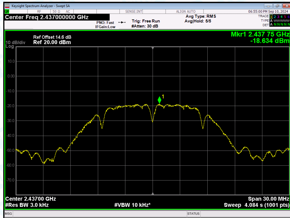
PSD NVNT b 2437MHz Ant1
