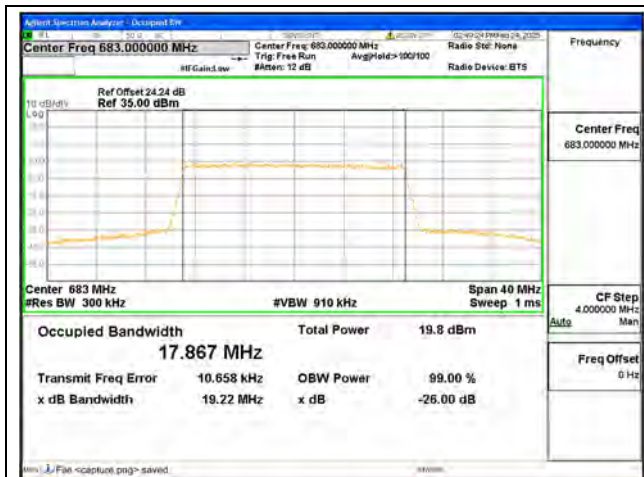
B71 / 20MHz / 64QAM/ Mid CH
