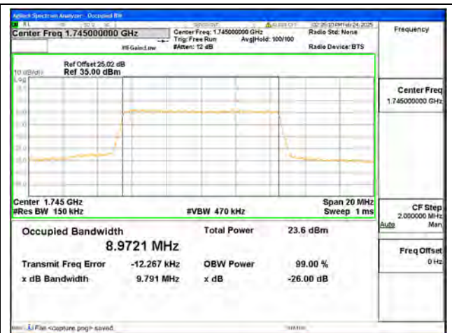
B66 / 10MHz / 256QAM/ Mid CH
