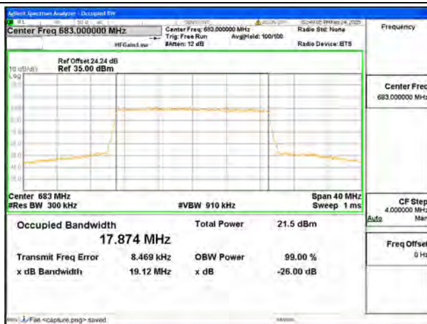
B71 / 20MHz / QPSK/ Mid CH
