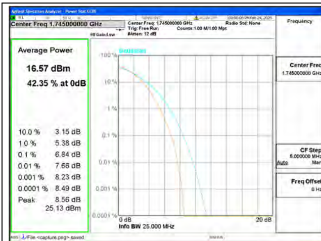
B66 / 20MHz / Mid CH / 64QAM
