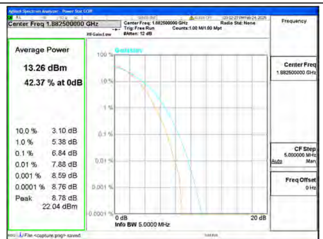
B25 / 5MHz / Mid CH / 256QAM
