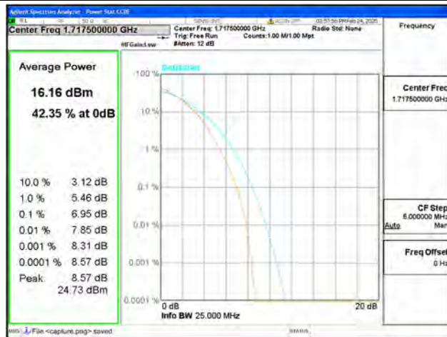
B66 / 15MHz / Low CH / 64QAM
