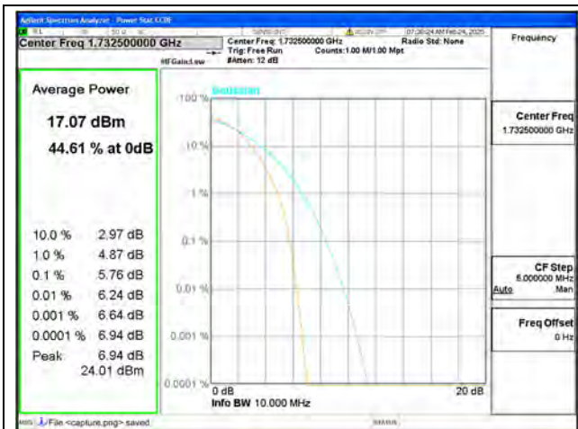
B4 / 10MHz / Mid CH / 64QAM
