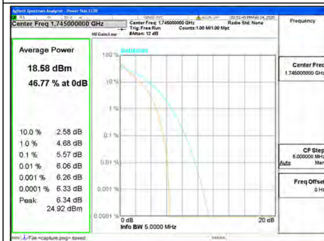
B66 / 1.4MHz / Mid CH / QPSK
