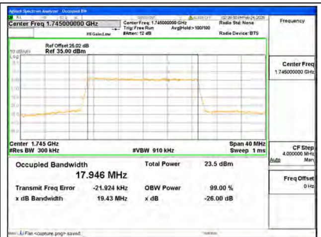
B66 / 20MHz / 256QAM/ Mid CH
