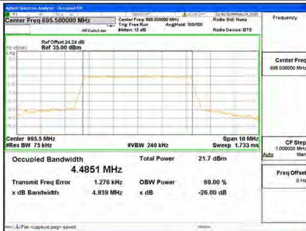
B71 / 5MHz / QPSK/ High CH
