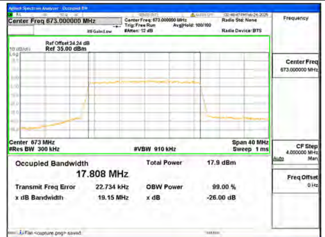
B71 / 20MHz / 256QAM/ Low CH
