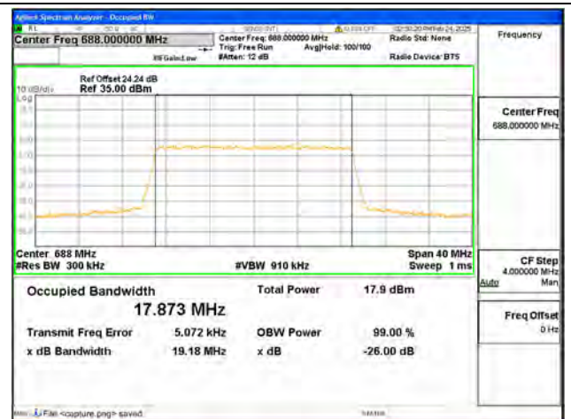
B71 / 20MHz / 256QAM/ High CH
