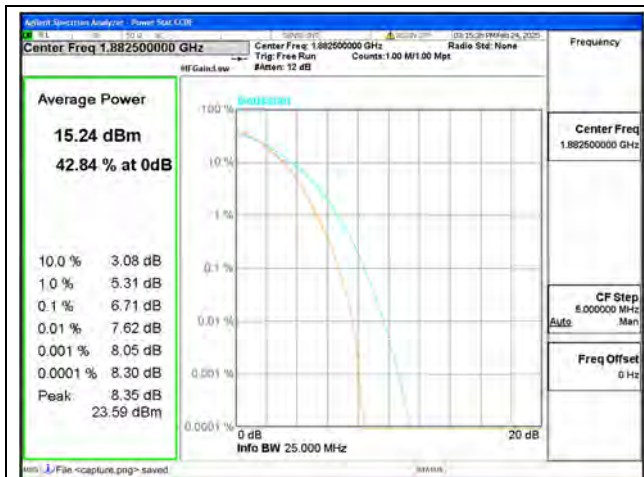
B25 / 15MHz / Mid CH / 64QAM
