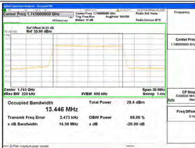
B66 / 15MHz / QPSK/ Mid CH
