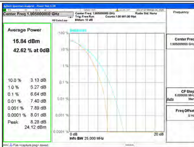
B25 / 20MHz / High CH / 64QAM
