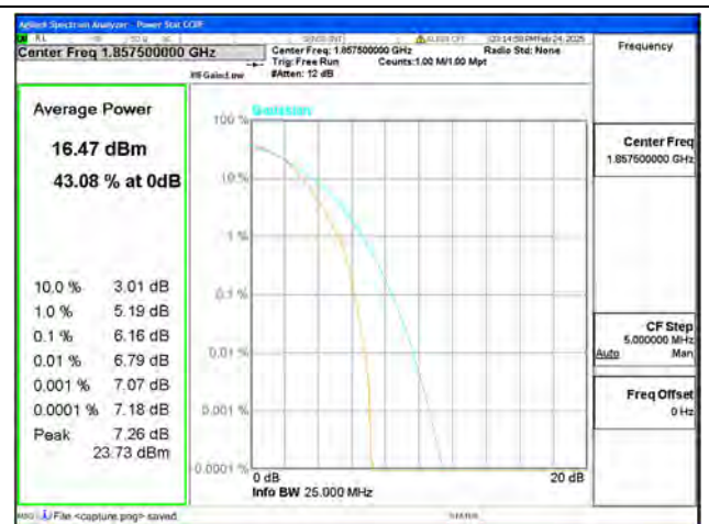
B25 / 15MHz / Low CH / 16QAM
