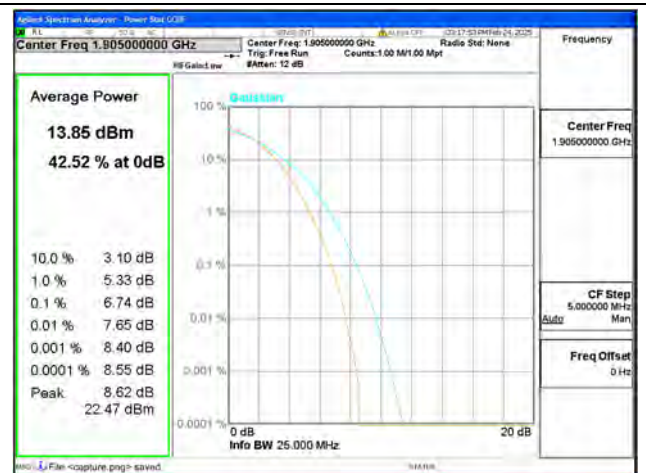
B25 / 20MHz / High CH / 256QAM
