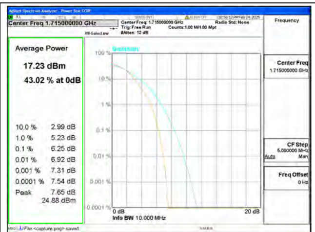
B66 / 10MHz / Low CH / 16QAM
