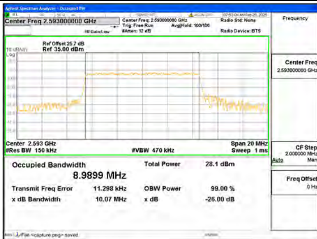
B41 / 10MHz / QPSK/ Mid CH
