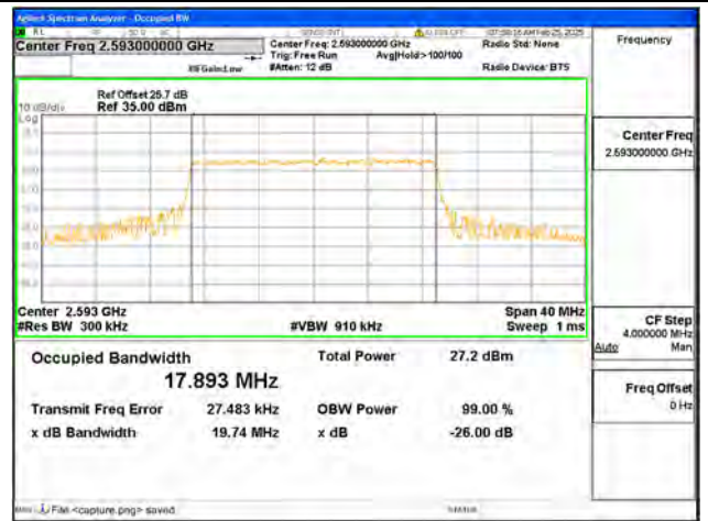
B41 / 20MHz / 16QAM/ Mid CH
