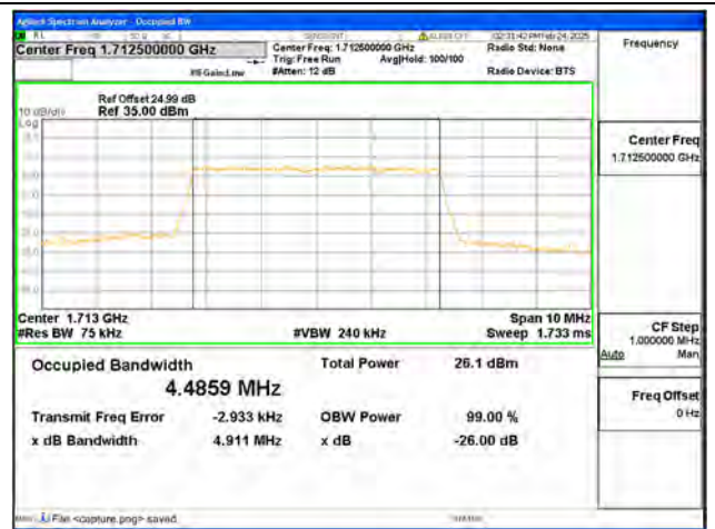
B66 / 5MHz / 16QAM/ Low CH
