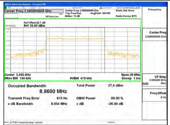
B38 / 10MHz / 16QAM/ Mid CH
