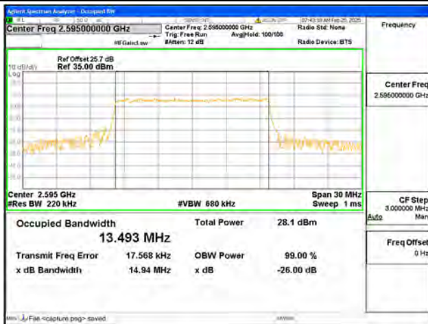
B38 / 15MHz / QPSK/ Mid CH
