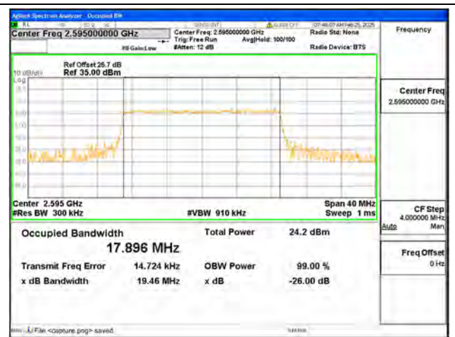
B38 / 20MHz / 256QAM/ Mid CH
