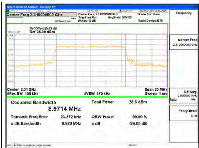
B40-1 / 10MHz / QPSK / Mid CH
