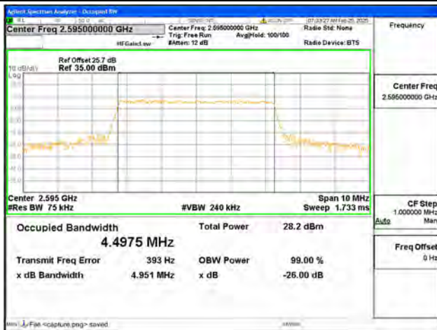
B38 / 5MHz / QPSK/ Mid CH
