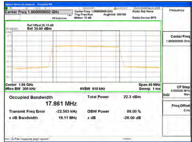
B25 / 20MHz / 256QAM / Low CH
