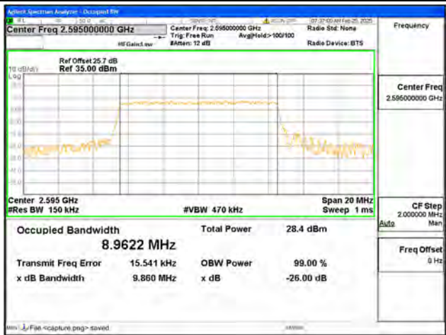
B38 / 10MHz / QPSK/ Mid CH
