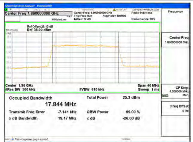
B25 / 20MHz / 16QAM / Low CH
