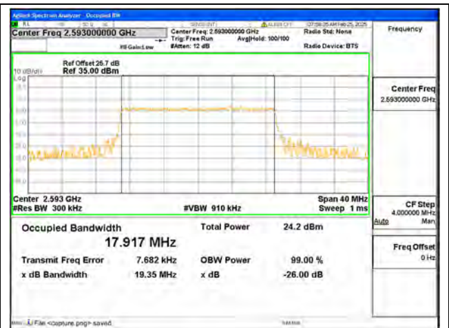
B41 / 20MHz / 256QAM/ Mid CH
