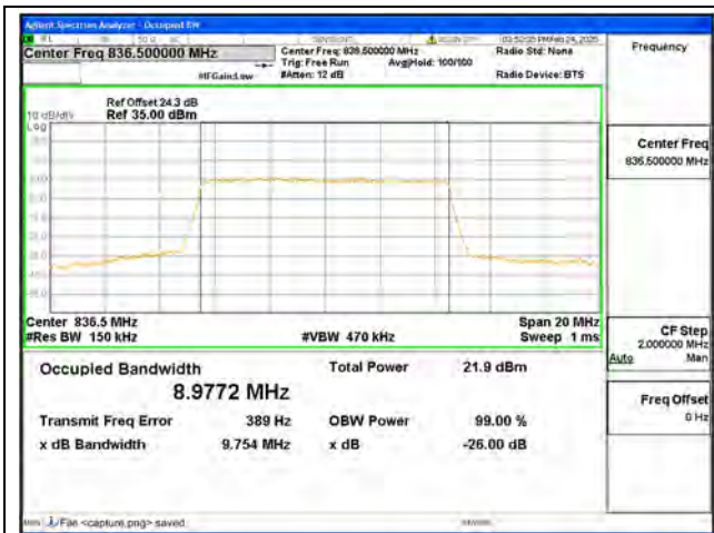
B26 / 10MHz / 64QAM/ Mid CH
