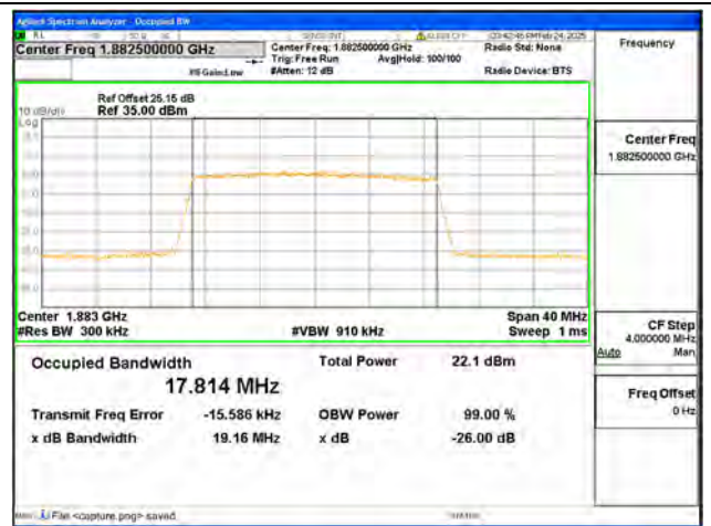
B25 / 20MHz / 256QAM/ Mid CH
