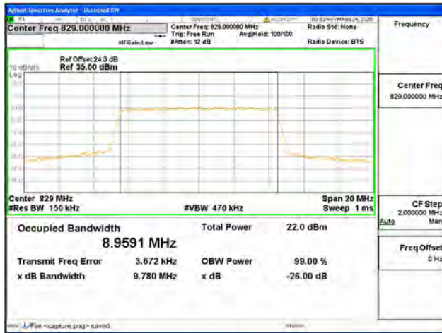
B26 / 10MHz / 64QAM / Low CH
