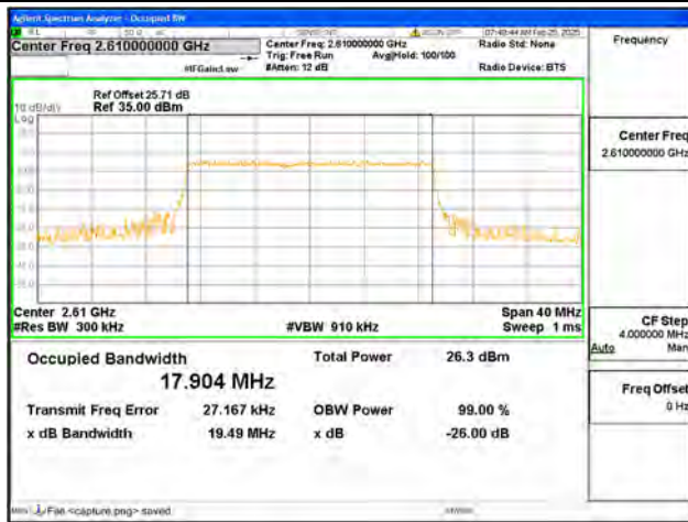
B38 / 20MHz / 64QAM/ High CH
