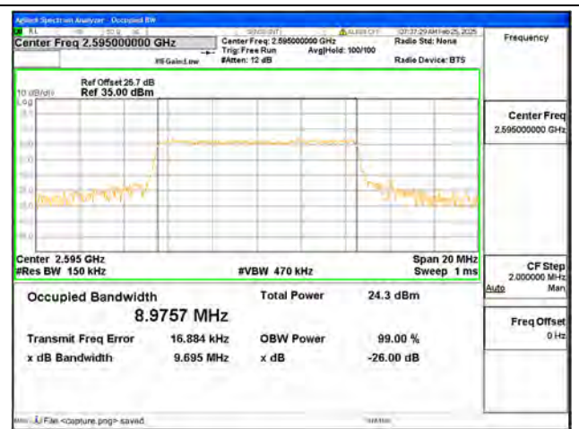
B38 / 10MHz / 256QAM/ Mid CH
