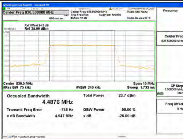
B26 / 5MHz / QPSK/ Mid CH
