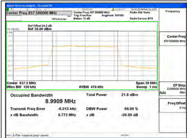
B19 / 10MHz / 64QAM/ Mid CH
