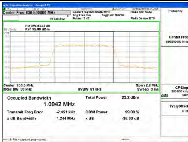
B26 / 1.4MHz / QPSK/ Mid CH
