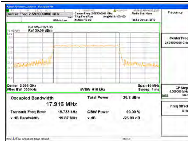
B41 / 20MHz / 64QAM/ Mid CH
