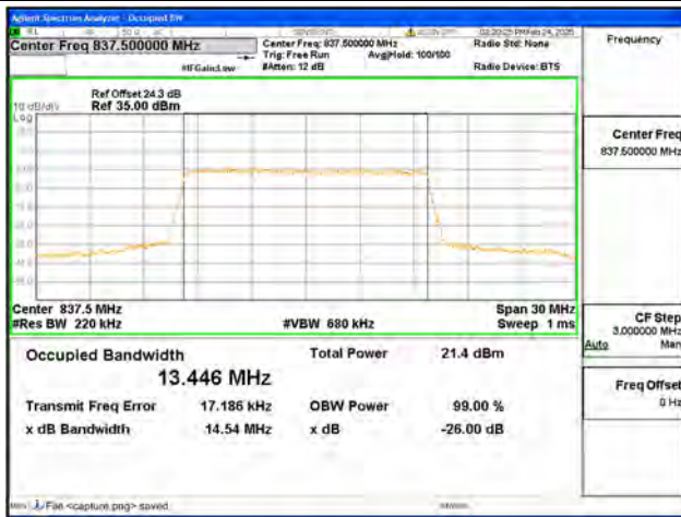
B19 / 15MHz / 64QAM / Low CH
