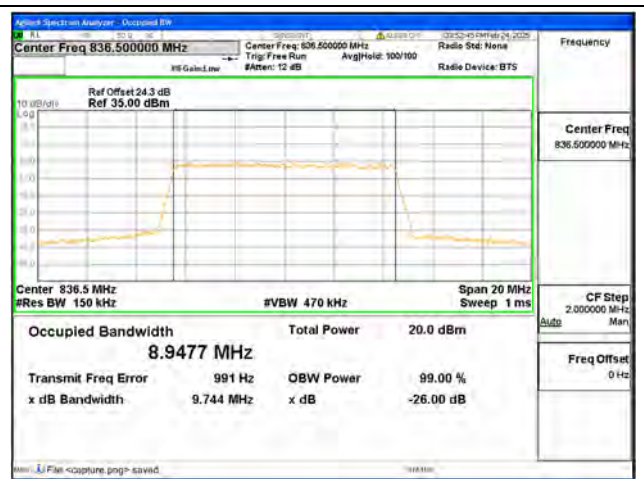
B26 / 10MHz / 256QAM/ Mid CH
