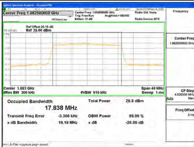
B25 / 20MHz / QPSK / Mid CH
