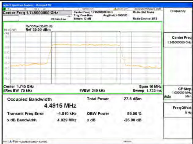
B66 / 5MHz / QPSK/ Mid CH
