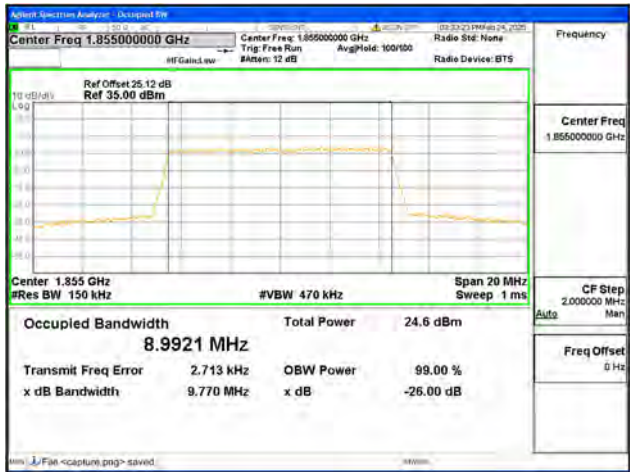
B25 / 10MHz / 64QAM / Low CH
