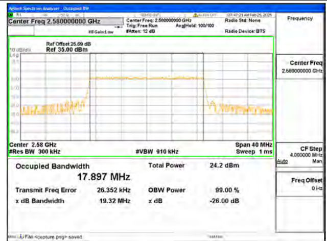
B38 / 20MHz / 256QAM/ Low CH
