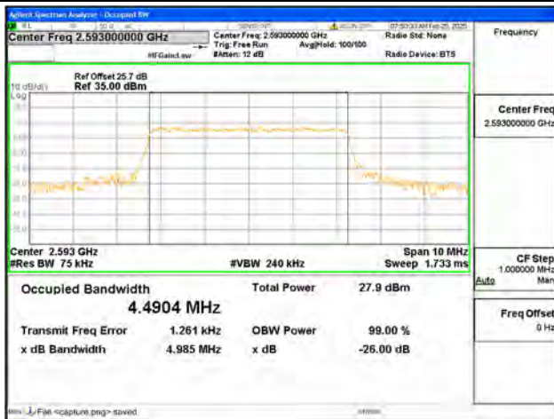
B41 / 5MHz / QPSK/ Mid CH
