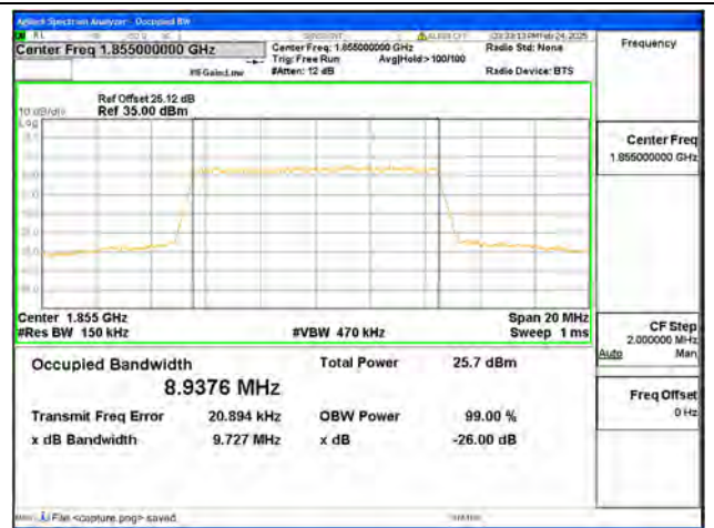
B25 / 10MHz / 16QAM / Low CH
