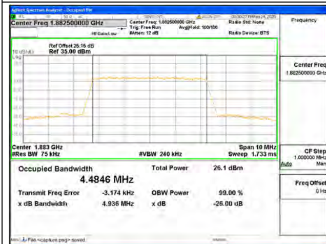
B25 / 5MHz / QPSK/ Mid CH
