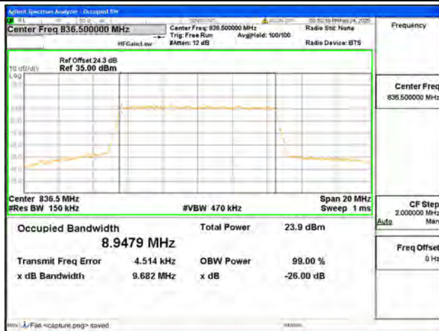
B26 / 10MHz / QPSK / Mid CH
