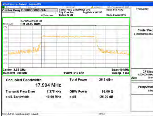
B38 / 20MHz / 64QAM/ Low CH
