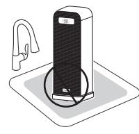
**Ne pas** utiliser l'appareil de chauffage dans une salle de bain, une buanderie ou tout autre endroit humide à l'intérieur.
