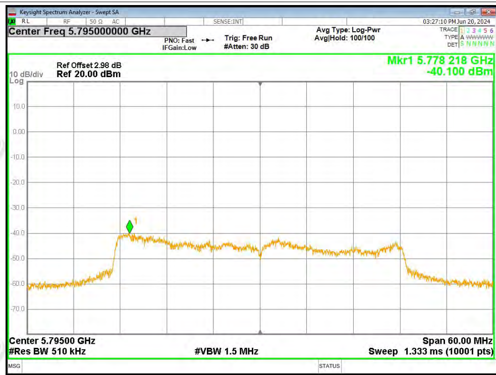
PSD NVNT n40 5795MHz Ant1
