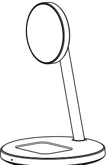
注意：1. 为确保充电安全正常，您必须使用9V2A以上的适配器和快充线（如用其他适配器或充电线，本充电器可能无法给你手机快充，甚至导致充电器损坏）；
