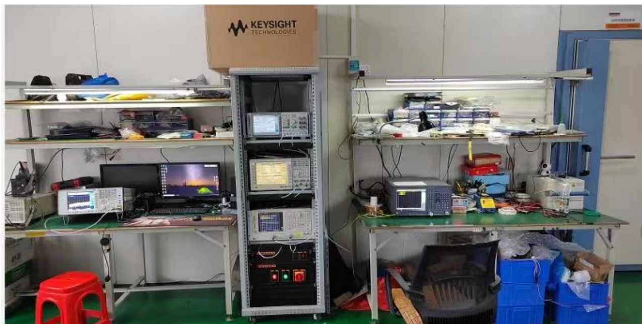
图 5 测试环境：OTA743 暗室，W500/8960 /8753ES/5071C，机器背向放置离标准喇叭天 4 米转台处
