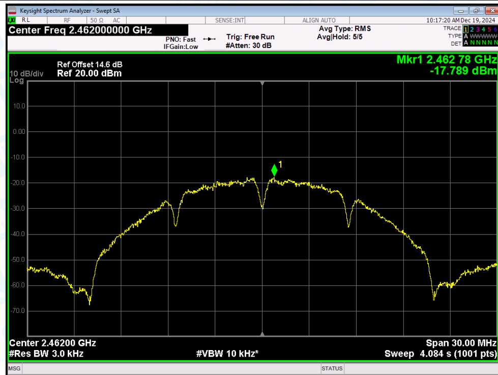
PSD NVNT g 2412MHz Ant1
