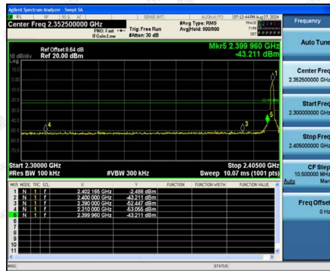
Left Band edge hopping off
