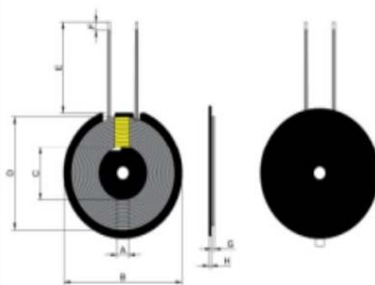
备注: 两根引线交接, 两线之间缠8mm高温胶带, 磁片背面贴双面胶
